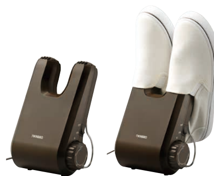
⑪ くつ乾燥機 SD-4546BR NEW 〈VKT-53〉 1-2480-1101 ¥8,000 150×90×H220 電源:単相100V 50/60Hz 消費電力:標準モード時150W、革靴モード時135W 使用温度範囲:0°C~40°C 騒音:52dB以下 電源コード:1.8m 質量:670g ●長靴から革靴、運動靴まで使えるくつ乾燥機。 ●折りたためるスタンド付きですっきり収納。 ●最大120分タイマーで消し忘れを防止します。
