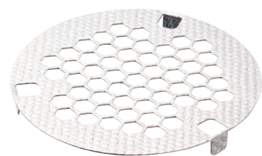
⑰ ステンレス パンチング目皿(足付) 〈QMZ-35〉 1-2195-1701 M20-745 φ 90×H10 ¥ 800 1-2195-1702 M20-746 φ105×H12 ¥1,000 1-2195-1703 M20-747 φ115×H12 ¥1,100 1-2195-1704 M20-748 φ165×H14 ¥2,000
