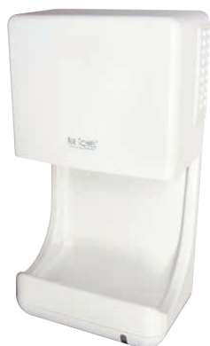
⑩ エアータオル KTM-100 〈KEA-11〉 1-1452-1001 ¥98,000 256×148×H490 電源:単相100V 50/60Hz 消費電力:ヒーターON 強650W・弱330W/OFF 強380W・弱115W 風速:強120m/秒 質量:4.7kg ●ハイパワー温風でスピード乾燥。 ●凹凸をなくした水受けカップでお手入れらくらく。 ●狭い場所へは水受けをはずして設置可能。
