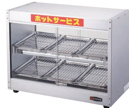
⑮ ホットショーケースESC-600LS(加湿機能内蔵) 〈EHT-64〉 ☎ 1-0832-1501 ¥140,000 600×300×H460 電源:単相100V・458W 温度調節:30~85℃(サーモ可変式) 扉開閉方式:両面スライドガラス 付属品:ケーキバット10インチ6枚 網21枚取6枚
