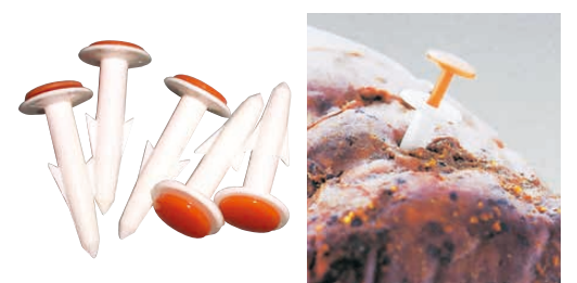
⑮ ポップアップタイマー ローストビーフ用 144S (100本入) 〈CPT-03〉 1-0581-1501 ¥8,000 φ12×H28 ●肉塊中にポップアップタイマーを差し込みます。 肉の表面から3cmの肉中温度が62°Cに達すると中心部分(オレンジ色)が飛び出して焼きあがったことを知らせてくれます。
