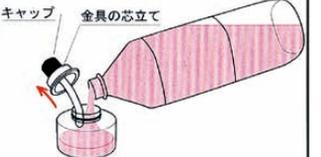
2. 芯立てを本体にはめ直し、平らな所に水平に置いてキャップを外し芯に着火して下さい。
