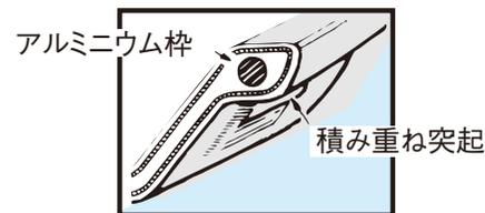
**アルミニウム枠の補強**
