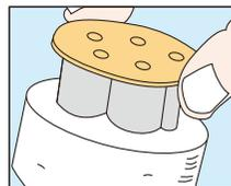
材料の中央にバランスよく抜型を押し込み抜き取ってください。
